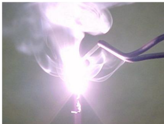
látka, ktorá vznikla horením horčika (oxid horečnatý)
